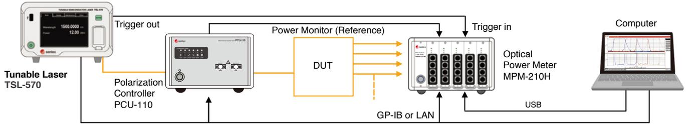
搭配功率计 MPM-210H 进行 IL 测试配置
