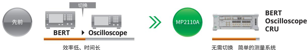
使用单个主机内的 BERT 和采样示波器，可一次捕获全部测量结果，并同时显示眼图。因此可以快速浏览评估多通道光模块和器件所需的所有测量结果，从而大幅度减少测量时间。
